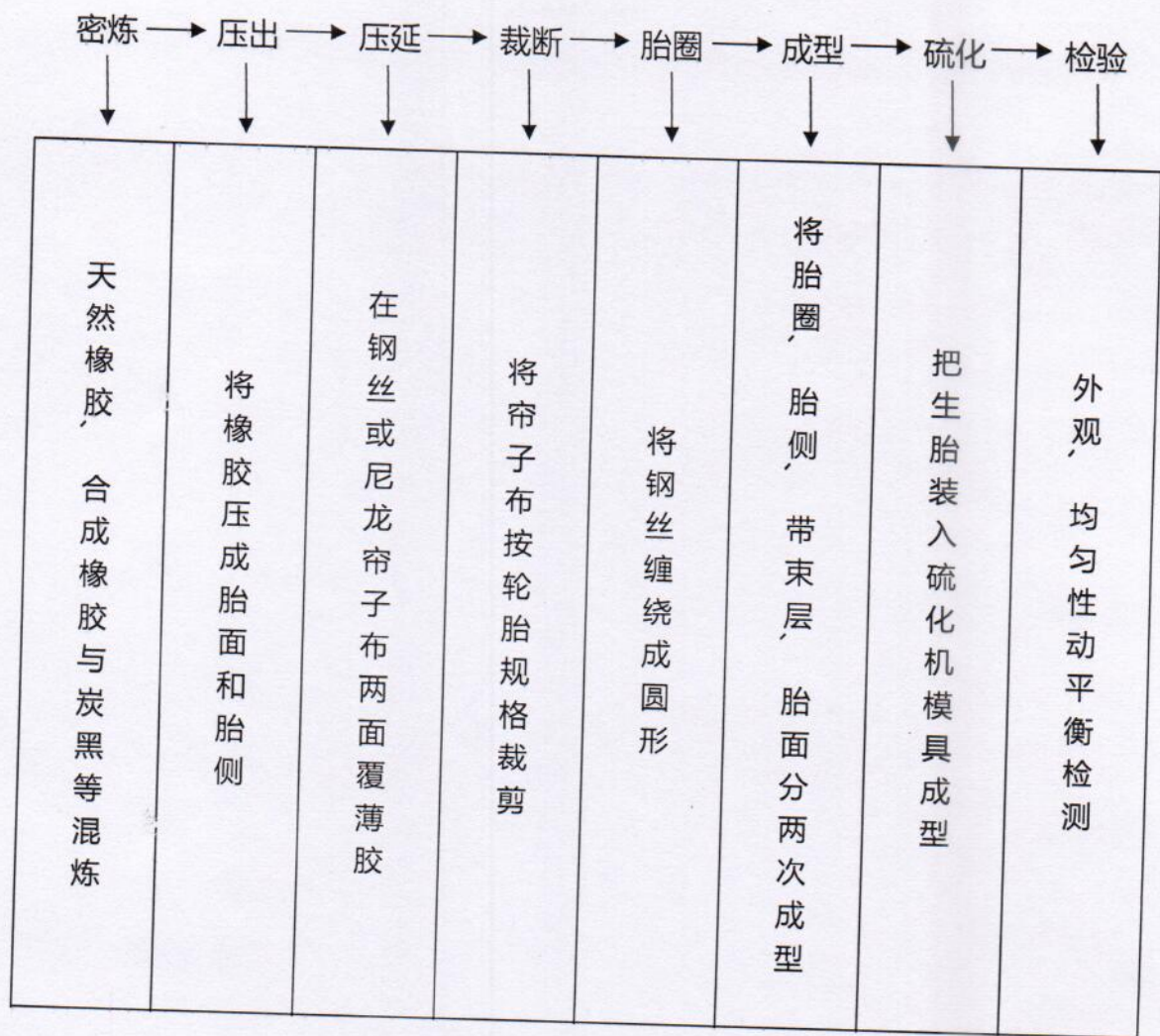
图 3-3 轮胎生产工艺流程图
